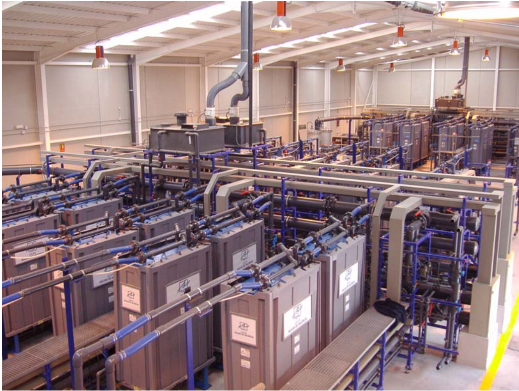
En la imagen se muestra una planta en servicio donde se utiliza la Electrodiálisis reversible como método de desalación.
